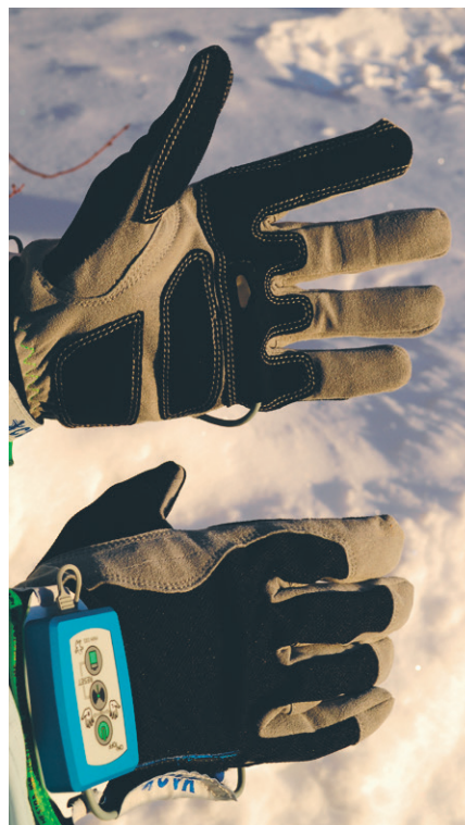
Cramos vibrationshandskar mäter vibrationer i handhållna verktyg vilket gör det möjligt att se vilken maskin som vibrerar för mycket.
