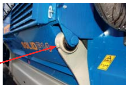
Pilen visar en gummibussning på en Rottne-skotare
